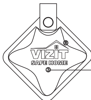
Рисунок 1 - RF-ключ VIZIT- RF2.2
